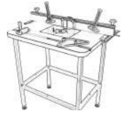
Fig 6 Zorg ervoor dat het tafelblad correct in de tafelopening is geplaatst. De bovenkant van het werktafelblad moet gelijkliggen met de bovenkant van de tafel.
